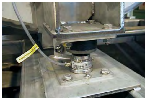
FÜLLSTANDSREGELUNG MITTELS WÄGEZELLE
