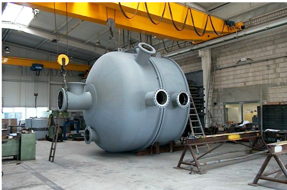
MANTELKÖRPER Ø 4300 / GESAMTGEWICHT DER 2 EINZELTEILE CA. 26 T
